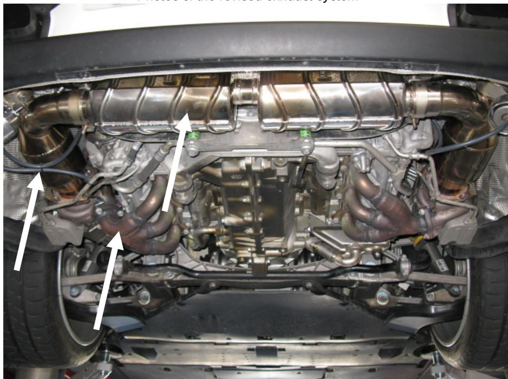
Pfeile von links nach rechts:Katalysator, Serienkrümmer, Endschalldämpfer
